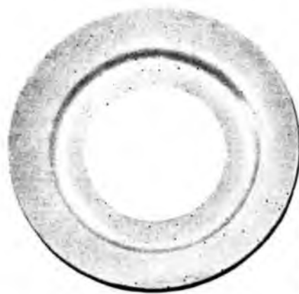
21-14. ábra. Szívóoldali lemez az első alakítási művelet után
