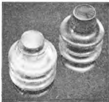
6-4. ábra. Elastirol FP poliésztergyantából készített szigetelőtestek bal oldalon: HCP/Co-rendszerrel hálósítva; jobb oldalon: benzoinnal hálósítva
