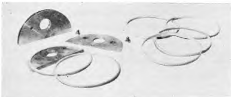
7-4. ábra. Gyűrűk és befogószerkezet NOL-RING testhez
